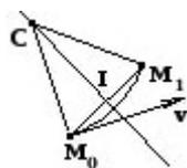
Il s'agit de tracer un arc de cercle partant de  $M_0$ , arrivant en  $M_1$  et tangent à  $\vec{v}$  en  $M_0$ . Dans FreeCAD le vecteur  $\vec{v}$  sera défini par son angle  $a$  avec l'axe des abscisses.
